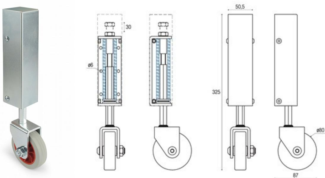
La regolazione consente una corsa verticale di oltre 30 mm., il prodotto supporta un carico fino a 130 kg. per arrivare ad impacchettamento della molla.
